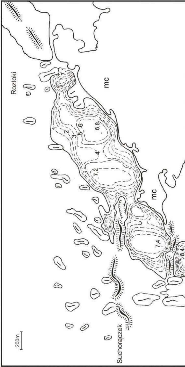
Ryc. 9. Ukształtowanie dna i miąższość osadów biogenicznych w zanikłym jeziorze Błota Roztoki
